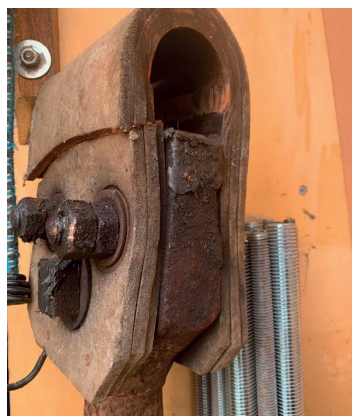
Battant avant réparation
